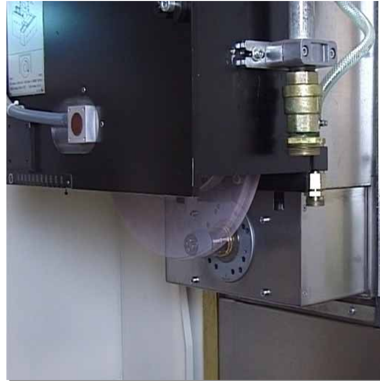
Einsatz Hinterschleifen Zusatzspindel in vorderer Position
