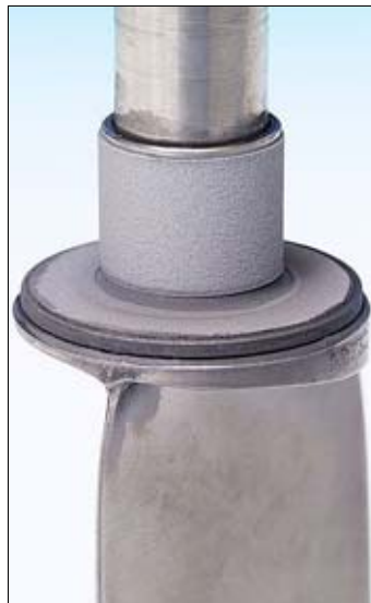
Detailbeeld van de coating die men nog moet rondslijpen
