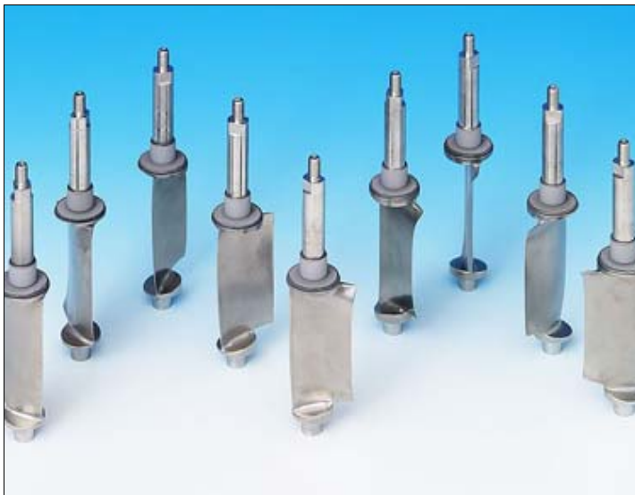
De turbineschoepen van Airbus die men eerst thermisch spuit met wolframcarbide en daarna naslijpt
