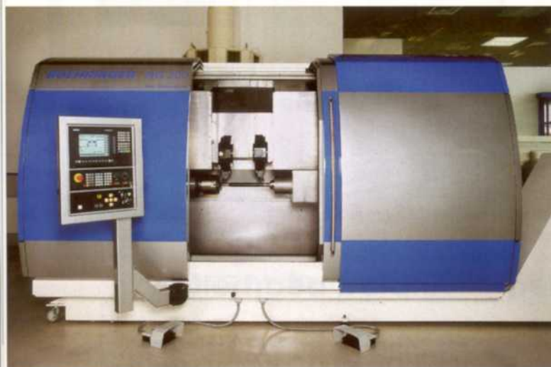
■ Die »NG200« bietet die technische Performance für die Hartbearbeitung mit der Option zur Integration des Tangentialdrehens
