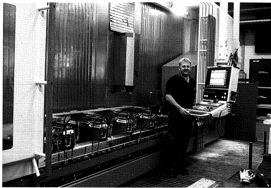
Statt eines starren Maschinentisches ist das Axa-Fahrständer-Bearbeitungszentrum bei der Firma Weinig mit speziellen Werkstück-Spanneinrichtungen ausgestattet, die sich mit unterschiedlichen Spannmitteln bestückt auf Schienen des Maschinenbettes auf vorbestimmte Positionen verschieben lassen
