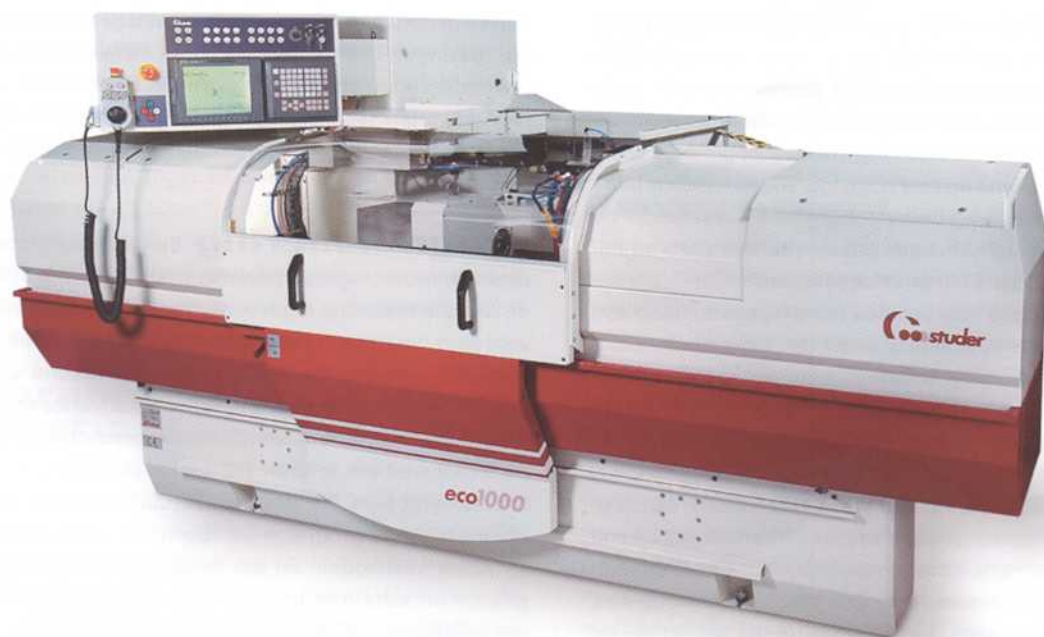
Eco1000: Verlengde buitenslijpbank te leveren in "high end" maar ook in "low cost" uitvoering.
