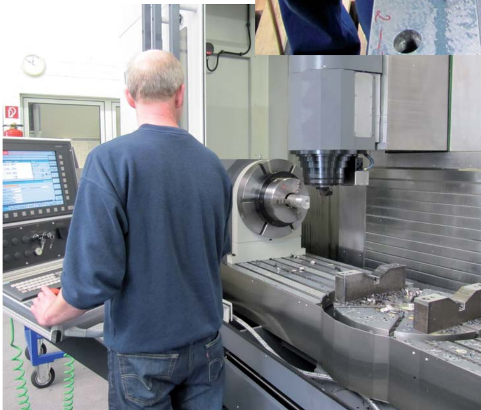
Een machine in de demoruimte van Axa in Schöppingen. In het midden van het machinebed de geïntegreerde rondtafel, daarboven een zwenkkop
