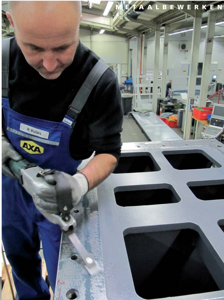
Het schrapen van een oplegvlak bij een portaal-machine in opbouw (foto's: Reinold Tomberg)
