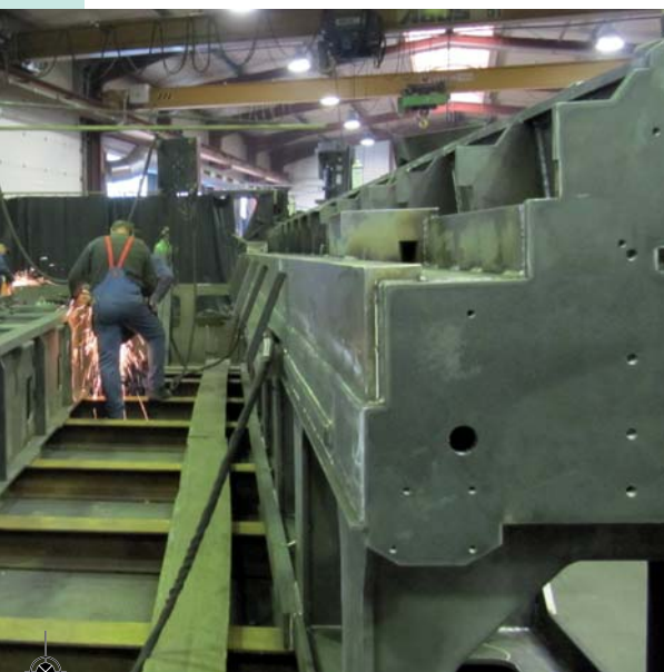
Het lassen van machineframes bij Axa. Elk frame is klantspecifiek
