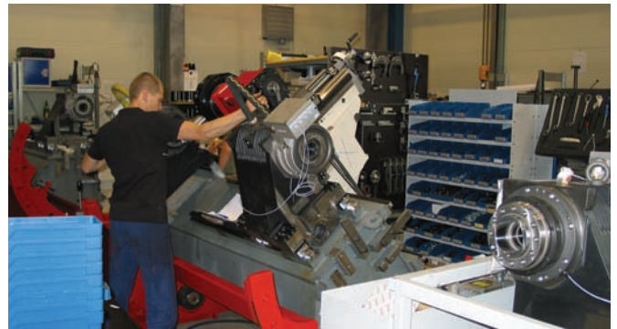
Kenmerkend voor de Emcoturn 420 MCplus zijn de dubbele hoofdspil, dubbele tegenspil en dubbel gereedschapstelsysteem, waarmee tegelijkertijd twee identieke producten te maken zijn (foto: Emco)
