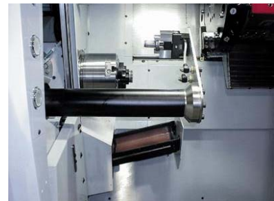
Bild 9: Der Schwenklader – integriert in die ET 345-II – transportiert das Rohteil zur Hauptspindel. Nach der Bearbeitung wird das Rohteil in die Ablaufrutsche gestoßen.
