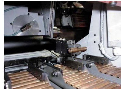
Bild 8: Mit dem am Schwenklader montierten Wellengreifkopf werden die Rohteile aus der Zuführung abgegriffen und in die Arbeitsspindel geladen.
