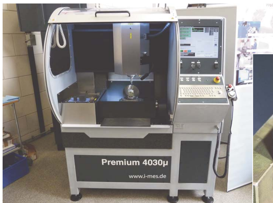
Vanuit volmateriaal grafiet werd zeer snel een aantal dunne naalden gefreesd op de nieuwe I-mes CNC-grafietfreesmachine
