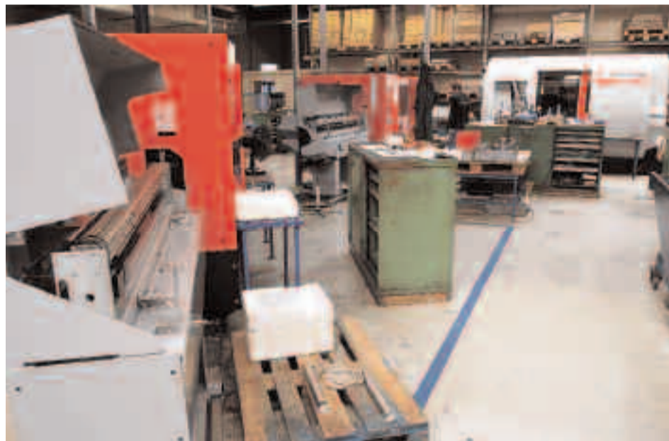
De drie Emco-draaibanken bij NTS Mans. Naast de Hyperturn zijn er nog twee 'Emco e65' draaibanken met automatische stafaanvoer, die na zes uur 's avonds onbemand doordraaien. (foto: FCP)
