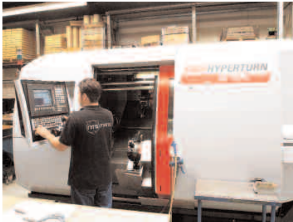
De 'Emco 665 Hyperturn' is een draaibank met een hoofd- en tegenspil en dubbele turret, zodat de twee spullen tegelijk kunnen draaien. Hierop werden de titaniumproducten gedraaid. (foto: FCP)
